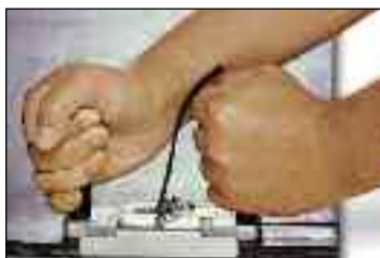
Нож для снятия части обкладки ленты
